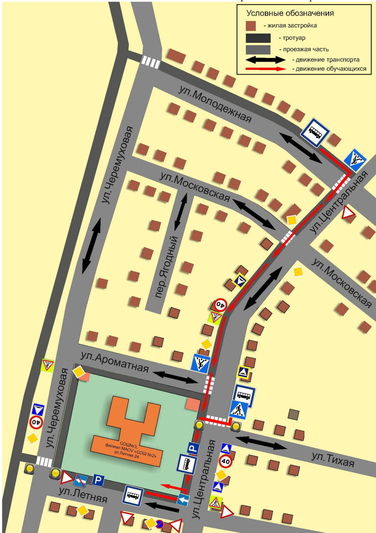
2. Схема организации дорожного движения в непосредственной близости от СОШ №3, филиала МАОУ «СОШ № 2», с размещением соответствующих технических средств, маршруты движения детей и расположение парковочных мест.
